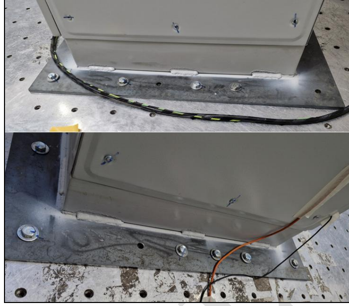
Resim 6. MAST'a bağlantı detayları
